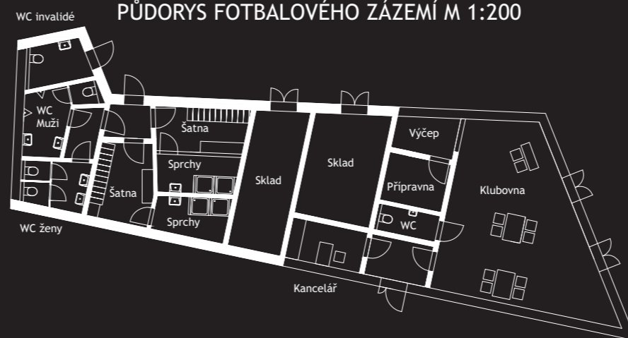
PŮDORYS FOTBALOVÉHO ZÁZEMÍ M 1:200
